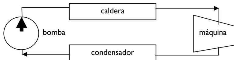
Una máquina de vapor opera entre dos focos caloríficos a  $250 \text{ }^\circ\text{C}$  y  $30^\circ\text{C}$ . Desarrolla 6 kW de potencia con un rendimiento del 65% del de una máquina de Carnot que trabaje entre los mismos focos térmicos. Se pide:
